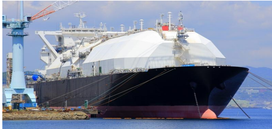
Moss-laiva "Senshu Maru" jossa venyttyt tankit ja jatkuvarakenteinen suojakuori, 2014.
