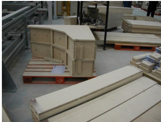
Myös erikoisen muotoisia eristelaatikoita tarvitaan runsaasti, ja ne on valmistettava erikseen käsityönä. Kuva: ML.
