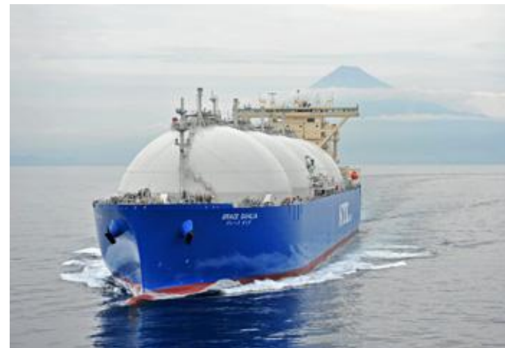
Toistaiseksi suurin Moss-laiva "Grace Dahlia" 177.000 m 3 . Kawasaki, 2014. Rakenteilla on samaan runkoon perustuva venytankkiversio
