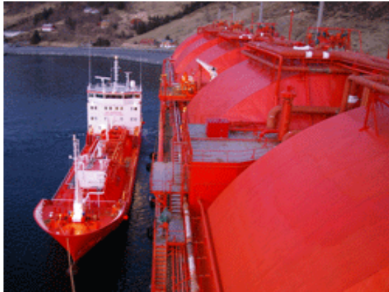
Maailman pienin 1100 m 3 LNG-laiva "Pioneer Knutsen", jossa kaasukäyttöinen diesel-sähköinen propulsiokoneisto. Ison LNG-laivan rinnalla, 2004.
